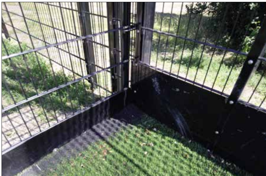
Forsøgene i Silkeborg omfatter også to højder banded rundt om banen for at se, hvor meget der skal til for at stoppe gummigranulat i at forsvinde ud gennem hegnet. (Arkivfoto: Erling Madsen).
